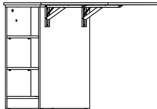
**ETAPA 11 - Com o produto montado fixá-lo na parede (caso a parede possuir rodapé utilizar o distanciador (N) para compensar a espessura do rodapé). Finalizado as etapas seu móvel está pronto para o uso.**
