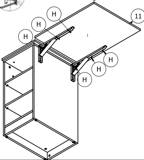
**ETAPA 8 - Fixar o suporte retrátil na lateral direita com parafusos.**
